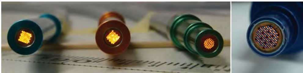
128根光纤合束，包含石英光纤（紫外+近红外），中红外光纤（硫系玻璃+多晶卤化银晶体），传输0.18μm~18μm光谱
